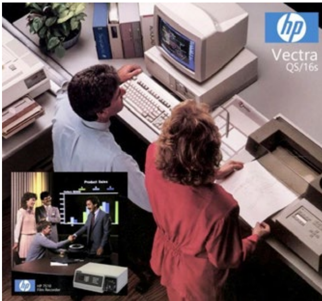
Figura 4. Imagen publicitaria de la computadora HP Vectra QS publicada en 1989. En la imagen grande se pueden apreciar tres dispositivos periféricos de gran importancia para el trabajo de Diseño de finales de los años ochenta e inicio de los noventa: Una impresora láser a la izquierda, una impresora de matriz de puntos a la derecha y una tableta digitalizadora con pluma (stylus) al centro, ésta última para trabajar específicamente con el programa AutoCAD, cuya caja puede verse detrás del monitor. Abajo a la izquierda puede verse un anuncio más de otro periférico para la producción gráfica, que en este caso muestra la filmadora de diapositivas modelo 7510, también producido por Hewlett-Packard.
